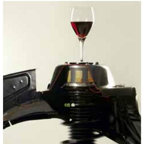
Kunden können vollständig integrierte Lösungen oder ein Add-on, ein Zusatzprodukt zu ihrer vorhandenen Lösung, wählen. Zurzeit entwickelt die ISYS Adaptive Solutions GmbH aktive Interfacestructuren zur Schwingungsreduktion in Kraftfahrzeugen und Schiffen. Hier hat das Kompetenzzentrum für Mechatronik und Adaptronik des Fraunhofer LBF Lösungen gefunden, die den Einsatz piezokeramischer Aktoren in solch hochbeanspruchten Anwendungen ermöglicht.
